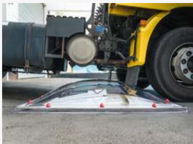
Test met Skylux pantserkoepel in polycarbonaat: de koepel breekt niet, maar plooit en springt uiteindelijk terug in zijn originele vorm
